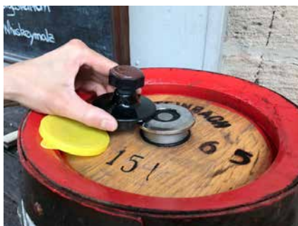
... und schieben von der Seite den Entlüfter auf den Metallfitting.
